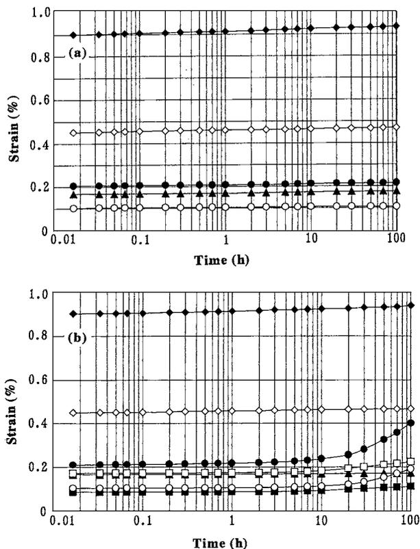
Figure 7 Bending creep test at 100°C (a) and 200°C (b). MSP ( $\square$ : 10 MPa,  $\blacksquare$ : 5 MPa), CFRP (MSP) ( $\bullet$ : 74 MPa,  $\circ$ : 37 MPa) FRP (PMR-15) ( $\blacklozenge$ : 639 MPa,  $\diamond$ : 320 MPa), SiC ( $\blacktriangle$ : 255 MPa).
